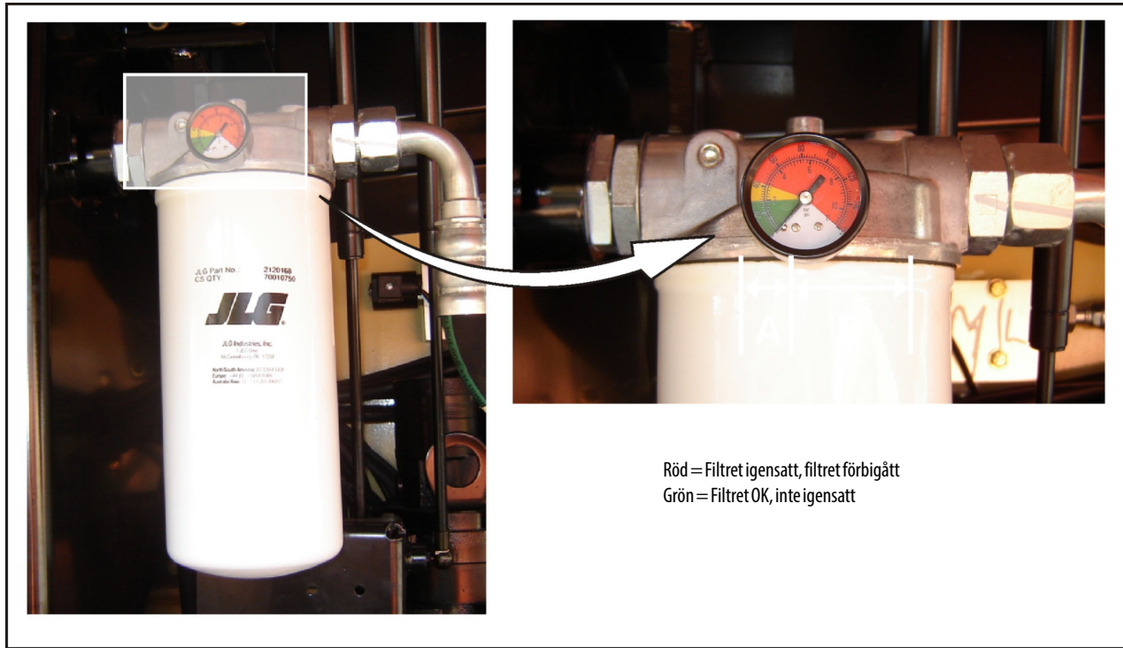
Fig. 7-8. Tillståndsindikator för hydraulfilter – Serienr 139396 tills nu
